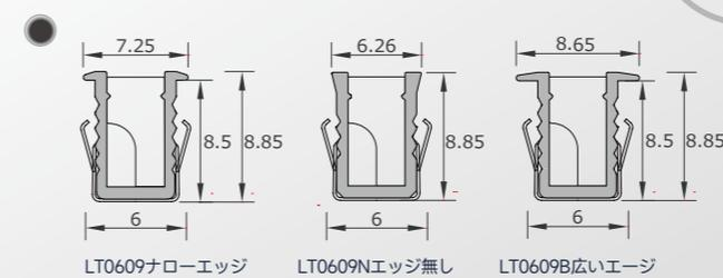
● カットアウト寸法: (W) 6× (H) 9mm
